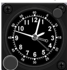
El reloj, situado en la consola auxiliar derecha, es un reloj de cuerda manual, de 8 días, con marcas de tiempo transcurrido hasta 60 minutos. En BMS, que se ajusta automáticamente a la hora de misión y no tiene los días en cuenta.
