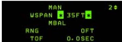
La página MAN se usa para establecer el ajuste el ancho de GUN EEGS Funnel para el fuego de cañón. El ajuste se introduce en pies y debe coincidir con la envergadura del blanco previsto. Por
