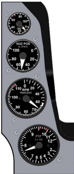
La pila de instrumentos derecha tiene cuatro indicadores todos ellos relativos al motor. El de más arriba es el de presión del ACEITE, el segundo el de posición de la tobera, el tercero el de RPM y el último el indicador de FTIT (Forward Turbine Inlet Temperature)
