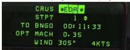
Cuando EDR es el modo seleccionando se coloca una marca en la cinta del HUD para dar una velocidad de referencia para la mejor autonomía a esa altitud. Es muy útil para patrones orbitales o cruceros de máxima permanencia, por ejemplo. Otra información proporcionada es la hora del bingo, Mach óptimo y viento.
