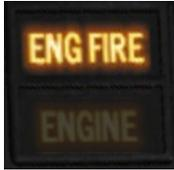
El encendido de ENG FIRE debe ir seguido por un corte inmediato de la aceleración llevando el throttle a idle (ralentí).
