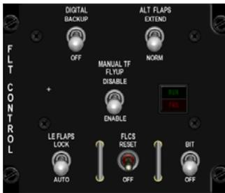
El interruptor DIGITAL BACKUP es un interruptor de dos posiciones que normalmente permite al piloto activar un volcado del estado del software del FLCS pero esto no está implementado en BMS todavía y el accionamiento del interruptor sólo produce el encendido de la lámpara DBU.
