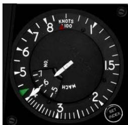
El medidor de Mach es un instrumento de vuelo primario que da velocidad indicada del aire en nudos (millas náuticas por hora) y en Mach. La velocidad indicada la proporciona la aguja exterior en la escala desde 60-80 hasta 800 nudos y el número de Mach por la aguja y la escala interiores.
