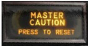
La luz Master Caution se enciende cada vez que alguna de las luces del panel de precaución se enciende (excepto IFF). Compruebe la luz de precaución específica y tome las medidas necesarias.
