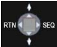
El DCS es un interruptor de cuatro posiciones momentáneas situado en la fila inferior del ICP, junto al interruptor DRIFT/CO - WARN RESET.
