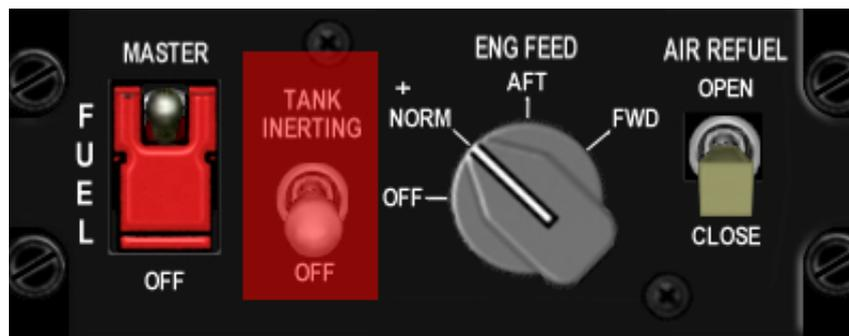
El switch tiene dos posiciones, MASTER y OFF y está protegido en la posición MASTER. En algunas fuerzas aéreas se asegura incluso con un cable y no puede ser movido por el piloto salvo en emergencia. En BMS este switch está siempre en MASTER, sobre todo al inicio en rampa. Nunca debería apagar el motor cerrando la válvula de combustible. Sólo debería cerrarla en caso de emergencia para evitar un incendio cuando se haga un aterrizaje forzoso, por ejemplo.
