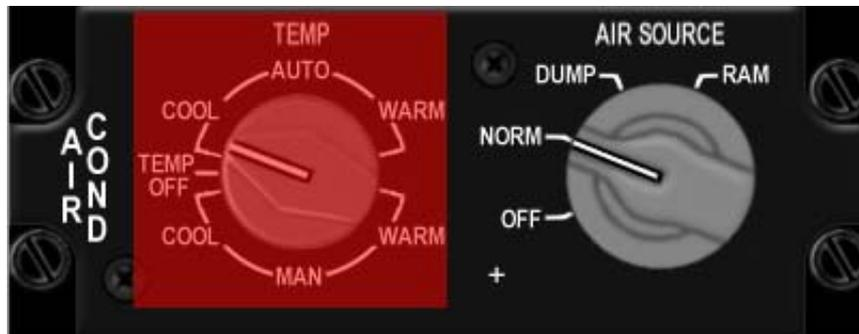
Este mando controla el sistema ECS y por tanto la presurización de la cabina y los tanques de combustible. Los tanques de combustible sólo están presurizados en las posiciones NORM y DUMP. En NORM, tanto cabina como tanques de combustible están presurizados; en DUMP sólo los tanques de combustible están presurizados.
