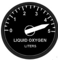
El medidor de oxígeno líquido marca el oxígeno que queda en litros en el depósito LOX.
