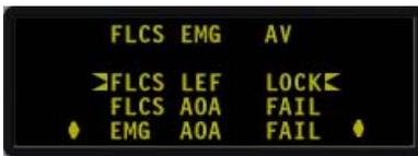
La Pantalla de Fallos del Piloto es del mismo tipo que la del DED y proporciona una lista de fallos detectados en todos los sistemas. La pantalla está en blanco hasta que se detecta un fallo; la luz MASTER CAUTION se enciende y en el PFD se muestra el fallo correspondiente.
