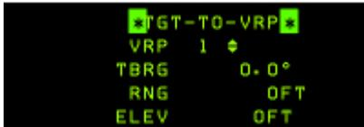
Esta página se usa para introducir los ajustes VRP. Éste se puede calcular manualmente pero se aconseja introducirlo con alguna herramienta como WDP. Estos datos se pueden cargar con el DTC y el WDP puede configurar el DTC automáticamente. No obstante, si tiene que introducir los datos manualmente, puede hacerlo en esta página. La página VRP debe estar mode selected (con la tecla cero)
