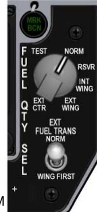
Nunca se olvide de volver a colocar la perilla en NORM tras los controles, porque NORM es la única posición donde se obtiene el correcto funcionamiento del sistema automático de trasiego de combustible, aviso de fuel retenido y aviso del cálculo de BINGO basado en el fuel del fuselaje. En otras palabras, ¡no tendrá avisos de TRAPPED FUEL o BINGO, si el mando no está en NORM!
