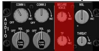
El panel Audio1 panel proporciona control del sistema primario de comunicaciones. A no ser que se indique lo contrario, los controles están activos independientemente de la posición del switchCNI en el panel AUX COMM
