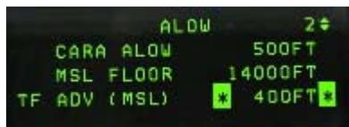
Mueva el scratchpad arriba y abajo con el DCS arriba y abajo para seleccionar el campo a editar.
