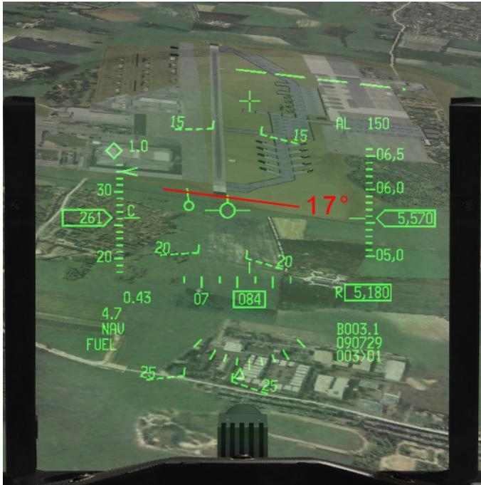
Como se puede ver en la imagen de la izquierda, si se inició el picado en el punto B2 el FPM se coloca en el punto objetivo que estaría a unos 17° desde el horizonte. Al ser un picado se aumentará la velocidad, incluso con los aerofrenos y el tren de aterrizaje desplegados. La velocidad será suficientemente alta para un aterrizaje seguro.
