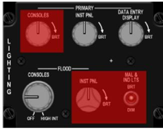
Las luces interiores no están totalmente implementadas en BMS. Sólo hay dos mandos disponibles para controlar la iluminación de cabina: el Primary INST PANEL para la luz de fondo y el mando Flood Console para las luces flood. Nota: cada mando tiene tres posiciones: OFF, DIM, BRIGHT.
