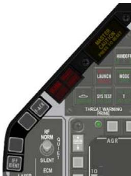
El eyebrow izquierdo se compone de una pila de pulsadores y otra de lámparas. Sólo está implementado un pulsador: el F-ACK. Pulsándolo, activa la pantalla PFL en la consola AUX derecha y enumera los fallos (ver la sección RIGHT AUX). El pulsador IFF no está implementado puesto que no podemos tener el sistema IFF en BMS.
