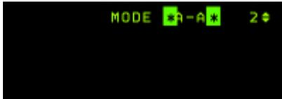
La página MODE proporciona una forma alternativa de cambiar el Master Mode sin utilizar los botones del ICP. Utilice el DCS a SEQ para cambiar el Master Mode y Mode Select con el 0 (cero) para activarlo. NAV es el modo por defecto cuando no están mode selected A-A o A-G.
