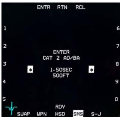
La forma en que se introducen los ajustes siempre la misma: Pulse el OSB (C1–C4) correspondiente y se mostrará la subpágina con la configuración en el centro de la página.
