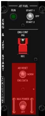
En BMS el principal objetivo de este panel es arrancar el motor. Esto se hace a través del switch JFS (Jet Fuel Starter). El JFS es una turbina de gas independiente y es iniciada por 2 JFS/freno acumuladores que son cargados automáticamente por el sistema hidráulico B. El JFS se utiliza para arrancar el motor en tierra y ayudar a su arranque en el aire.
