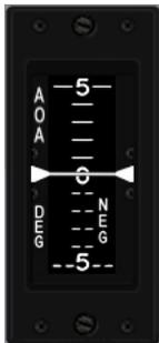
El indicador de AoA, situado en el panel de instrumentos, muestra el AoA actual en grados. El indicador muestra una cinta de movimiento vertical que indica un rango operativo de -32 hasta aproximadamente +32 grados. La cinta está codificada en colores de 9 a 17 grados para coincidir con el código de colores de los símbolos del AoA indexer. El es marcado con un OFF cuando no recibe alimentación.
