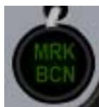
El marcador beacon está a la derecha del HSI y encima del panel FUEL QTY. A diferencia de la aviación general donde los marcadores difieren por el color; en el F-16, sólo es verde pero parpadea a diferente frecuencia (con variación de tono de audio) en función de la radiobaliza sobrevolada.
