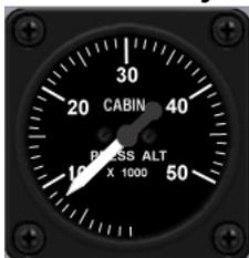
El medidor de presión en cabina indica la presión en cabina por altura de cero a 50.000 pies.
