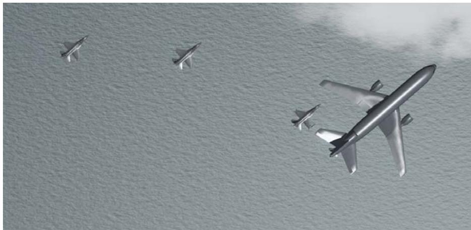
3. Líder termina repostaje y se mueve a la ala derecha del tanker. #2 contacta, #3 se cierra a echelon sobre #2. #4 está esperando en posición.
