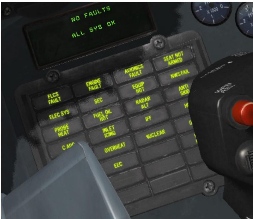
El panel de luces de precaución se encuentra en la consola auxiliar derecha. Es un marcador para 32 indicadores, de los cuales 20 están totalmente soportados por BMS. La luz ELEC SYS no se puede resetear con la luz MASTER CAUTION. La única manera de resetearla es utilizar el botón ELEC CAUTION RESET del panel ELEC. Puede que en algunas situaciones no se pueda resetear. Algunas luces como AVIONICS FAULT, ENGINE FAULT y FLCS FAULT se pueden resetear con el botón F-ACK (mensaje PFLD).
