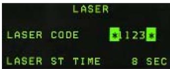
El scratchpad es un área editable que admite valores alfanuméricos de las teclas del ICP. El scratchpad se muestra en el DED entre dos asteriscos.
