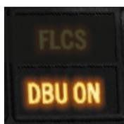
La luz de aviso DBU se enciende cuando el FLCC se ejecuta en modo de respaldo digital. Se trata de un regalo para la vista en BMS y sólo ocurre cuando se prueba la DBU.
