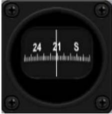
La brújula magnética es totalmente autónoma y no necesita ningún sistema de corriente para funcionar. Es su último instrumento de navegación de reserva. Se muestran los cuatro puntos cardinales así como marcas cada 30°.
