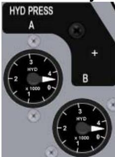
El sistema hidráulico es un sistema doble redundante etiquetado A&B. Verá dos relojes de presión hidráulica pues. La presión normal operativa está entorno a los 3100 PSI (agujas en posición 12 en punto). Los sistemas críticos están atendidos por ambos sistemas A y B y por tanto sólo fallaran cuando ambos sistemas hidráulicos se hallan quedado sin presión. La EPU proporciona presión hidráulica de emergencia al sistema A siempre que se necesite pero está limitada en autonomía.
