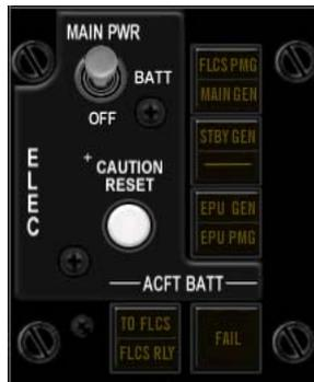
Los fallos de un generador no están codificados en BMS por el momento, por lo que cuando la luz de precaución ELEC SYS se encienda compruebe las luces ELEC correspondientes y pulse el botón ELEC CAUTION RESET para tratar de resetear el fallo. Si no se resetea, aterrice tan pronto sea posible.
