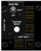
El sistema eléctrico del F-16 real es bastante complicado con un sistema principal de alimentación de AC distribuyendo corriente a los buses no esenciales, esenciales y de emergencia. Un sistema de alimentación AC en espera distribuyendo energía a los buses esenciales y de emergencia y un suministro de energía AC de Emergencia distribuyendo energía a los buses de emergencia. Y un suministro de energía DC y otro para el FLCS.
