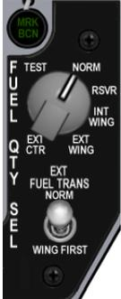
El panel Fuel Quantity se compone de un mando de 6 posiciones y switch de dos posiciones. El mando superior controla la cantidad de combustible presentada en el indicador fuel QTY en la consola DERECHA AUX.
