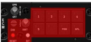
Debido a su naturaleza y al hecho de que la mayoría de sistemas ECM son clasificados, este panel no está implementado. El único switch utilizado en BMS es el conmutador etiquetado OPR, STBY, OFF. BMS sólo utiliza la posición ON/OFF y este switch se tiene que colocar en OPR para que el pod de ECM pueda recibir alimentación (si lo hubiere)
