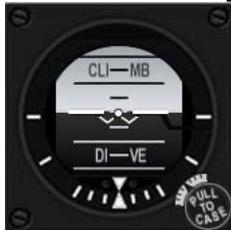
El ADI de respaldo se localiza encima del MFD Derecho y es el instrumento de respaldo primario de actitud de vuelo. No necesita alimentación y funcionará siempre que el ADI principal esté marcado como OFF.
