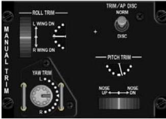
El panel de TRIMADO Manual proporciona un al piloto un método adicional para trimar la aeronave. Los trimados Primarios (roll & pitch) están en el stick. Las ruedas e indicadores de MANUAL TRIM proporcionan una forma de respaldo para ajustar los trimados usando los mandos adecuados. El trimado del Timón sólo se puede ajustar en el panel MANUAL TRIM mediante el potenciómetro YAW TRIM.
