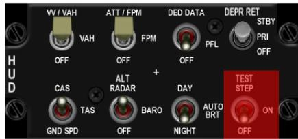
El panel HUD permite al piloto ajustar muchos parámetros en el Head Up Display. El panel está dispuesto en dos filas de cuatro conmutadores:
