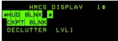
La página HMCS (Helmet Mounted Cueing System) permite controlar el sistema de información integrado en el casco. La primera línea permite la supresión del HUD cuando está Mode selected. El HMCS no se mostrará cuando esté mirando al HUD.
