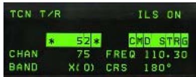
La primera línea del DED da el estado del TCN y del ILS. (El ILS se pone ON/OFF con el mando ILS en el panel AUDIO2). El scratchpad está a la izquierda entre dos asteriscos y ahí es donde se introducen las frecuencias TACAN e ILS. El sistema es capaz de diferenciar un canal TACAN válido (0-126) a partir de una frecuencia ILS válida (VHF 4 o 5 dígitos). La siguiente línea muestra el TACAN
