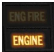
La luz de advertencia ENGINE, se enciende debido a otros problemas de motor. Las causas incluyen apagado del motor, fallo del alternador, sobre temperatura ...
