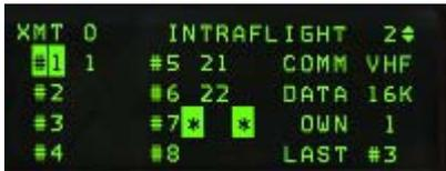
Si el DCS se mueve a SEQ se muestra la subpágina INTRAFIGHT que permite al piloto seleccionar hasta 7 direcciones del equipo. Aquí es donde las otras direcciones IDM del vuelo tienen que ser introducidas para poder permitir el Data-link con ellos en los modos A-A y A-G. Ownship (#1) no se puede cambiar. En general use la primera columna para su propio vuelo y la segunda para los otros vuelos. Simplemente
