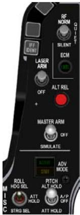
El panel MISC puede diferir de un avión a otro. BMS usa el panel MISCelánea de la versión 50/52 que contiene los interruptores Autopilot, TFR, Master ARM, Laser y RF.
