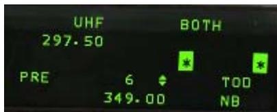
Al pulsar el botón del ICP COM1 se abrirá la página de radio UHF. La primera línea muestra el estado de la radio; en este caso está ajustada en BOTH (Preset y Guardia) y la frecuencia está ajustada en 297.500 Mhz. El scratchpad está listo para recibir una nueva frecuencia o un nuevo canal. Otro modo de cambiar la radio UHF es usando los botones del ICP NEXT/PREV para cambiar directamente
