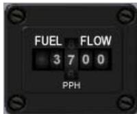
Localizado encima del MFD Derecho, este indicador muestra el Flujo de Combustible actual consumido por el motor (incluido en Postcombustión) en libras por hora (pph). El indicador tiene un rango de cero a 80.000 pph y es alimentado por el bus de emergencia.
