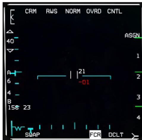
**OSB #1** indica el modo actual del FCR y si se pulsa muestra una página donde se pueden elegir los otros modos desde los botones laterales del MFD: GM (Ground Mapping), GMT (Ground Moving Target), SEA (Anti-Ship), STBY (Standby) a la derecha y CRM y ACM (Air Combat Manoeuvring) a la izquierda. Pulsando cualquiera de los OSBs correspondientes se entrará en ese modo. Observe que el modo BCN (Beacon) no está implementado.
