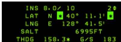
La página INS se refiere al Sistema de Navegación Inercial. Se compone de 5 líneas. La primera da el estado del INS (estado 10 significa totalmente alineado), y como siempre el steerpoint activo puede cambiarse sin salir de la página con los botones NEXT/PREV del ICP. La segunda línea da la latitud actual y la tercera la longitud actual. La siguiente línea proporciona la altitud barométrica y la
