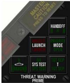
El panel Threat Warning Prime está situado junto al RWR (Radar Warning Receiver). Muestra y gestiona la información presentada en el RWR. Se compone de 6 pulsadores cuadrados en combinación con lámparas excepto el indicador Missile Launch.
