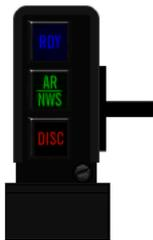
El indexer DERECHO lo componen tres indicadores de color dispuestos verticalmente. La superior es azul y etiquetada RDY. Es relevante para el sistema AIR- REFUEL y se enciende cuando el sistema está listo para el reabastecimiento AIR - AIR. En BMS, este indicador se enciende en cuanto la compuerta AR está abierta.
