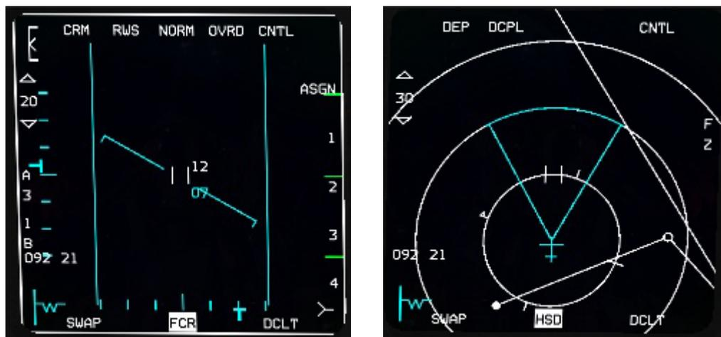
**OSB #19 y 20** se utilizan para ajustar el alcance del FCR cuando el modo lo permite. Pulsando el OSB #19 OSB #19 se reduce el alcance y con el OSB #20 se aumenta. Otra forma de ajustar el alcance es con el cursor bumping (si el FCR es SOI) cuando el cursr toca el borde superior o inferior del FCR.
