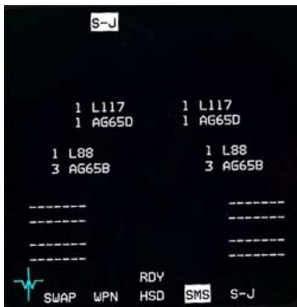
La primera pulsación del OSB junto a una estación, selecciona la(s) carga(s) y una segunda pulsación selecciona el bastidor si está disponible para desechar. En la imagen de la izquierda, L117 son los bastidores de Maverick y los L88 los de las AGM-88.
