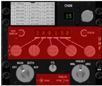
La única radio de reserva disponible en la cabina del F-16 es la de UHF. No hay radio VHF de reserva. Para usar la radio de reserva, el switch CNI del panel AUX COMM tiene que estar en la posición BACKUP.
