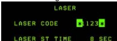
Esta página se usa para ajustar el sistema Láser. Se compone de dos líneas. La primera establece el código de láser, que normalmente coincide con el código del pulso láser objetivo y que no está implementado de momento y la segunda línea establece el temporizador láser. El targeting laser se activa para el guiado final del arma xx segundos antes del impacto. El contador ajusta los xx segundos; por defecto a 8 segundos y se carga con el DTC.
