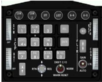
El ICP (Integrated Control Panel) es la interfaz principal entre el piloto y los sistemas de la aeronave. Es parte del UFC (Up Front Control) Control) compuesto por el ICP y el DED (Data Entry Display) donde el ICP es el teclado y el DED la pantalla.
