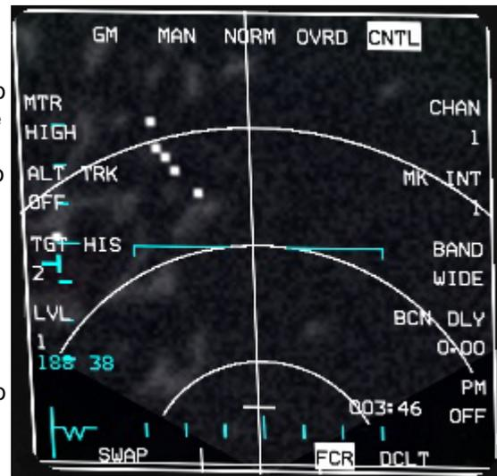
**OSB #7** es FZ de Freeze. Cuando se pulsa, la imagen AG FCR se congela y las coordenadas del punto terrestre estabilizado se muestran en la parte superior derecha del MFD. El acimut y distancias se muestran en la parte inferior izquierda del MFD.
