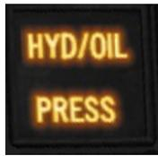
Esta luz de aviso indica una condición de baja presión en uno o en ambos sistemas hidráulicos, o una condición de baja presión de aceite del motor. Por tanto se tendrán que comprobar ambos sistemas:
