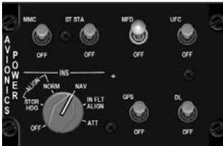
Como indica su nombre, el panel de Alimentación de la Aviónica se utiliza para alimentar los sistemas de aviónica. Se compone de 6 interruptores y un mando INS.
