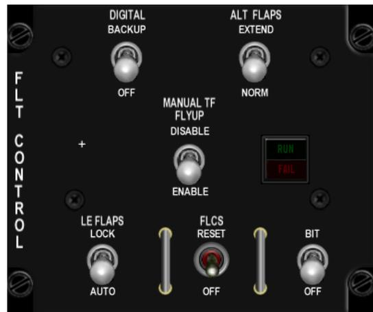
La siguiente prueba es el funcionamiento del Digital Backup, basta con sacar de la posición OFF el switch DIGITAL BACKUP y comprobar que DBU se enciende en el eyebrow derecho. Mueva los controles de vuelo y compruébelos visualmente para ver que funcionan correctamente. Una vez satisfecho, ponga el switch en posición OFF y compruebe que la luz DBU se apaga.
