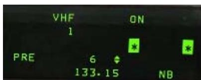
El botón del ICP COM2 muestra la página de radio VHF. La primera línea muestra el estado de la radio, en este caso está ON y la frecuencia seleccionada es el canal #1.
