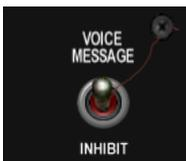
El panel Voice Messaging System (Sistema de Mensajería por Voz - VMS) incluye un único interruptor. Cuando se coloca en la posición INHIBIT, el VMS quedará inhibido (Bitchin' Betty permanece en silencio) y cuando se coloca en la posición superior, el VMS está operativo.
