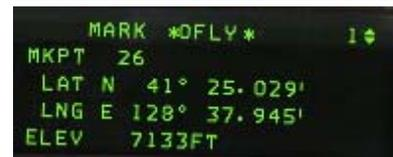
El markpoint se crea manualmente moviendo el HUD mark cue (HMC – a pequeño círculo desplazable cerca del FPM en pre-designado) con el cursor (HUD SOI) y moviendo el TMS hacia arriba. La primera pulsación estabilizará en tierra el HMC y el segundo TMS-up grabará el markpoint. HMC debe estar en tierra para una correcta implementación, pues apuntando al cielo obviamente no funcionará.
