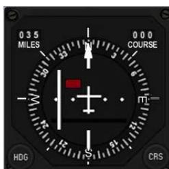
El HSI (Horizontal Situation Indicator) es el instrumento de vuelo principal para la navegación. Ofrece un vista cenital de su avión en el centro y una brújula alrededor de él. Su uso se explica totalmente en el tutorial cartográfico que explica la radio navegación básica y avanzada.
