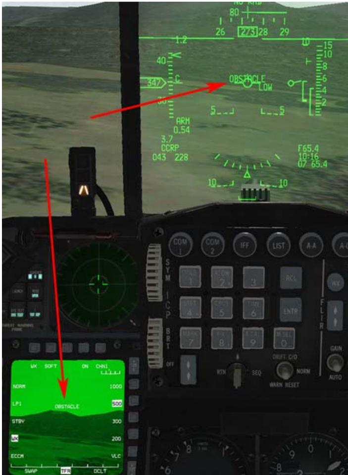
Cuando el TFR está en NORM tendrá protección automática durante el vuelo. En el HUD y en el TRF MFD se presentan el mensaje OBSTACLE o Fly-Up y el avión se eleva para evitar el terreno.
