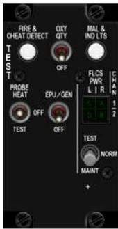
El panel de pruebas se utiliza obviamente para realizar algunos tests en diferentes sistemas durante el arranque en rampa. En BMS, todos los interruptores y pulsadores están implementados, excepto el interruptor FLCS TEST en su posición MAINT (Mantenimiento).
