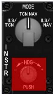
El mando inferior del Modo Instrumento no está implementado en BMS. En la realidad se usa para corregir la desviación en demora del INS, lo que nunca ocurre en el sim. El superior es un mando de cuatro posiciones para ajustar el Modo Instrumento: ILS/TCN – TCN – NAV – NAV/ILS.
