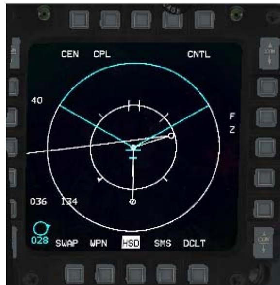
**OSB #3:** Cuando el HSD es SOI, el OSB #3 etiquetado NORM/EXPAND cambia el FOV (Field of Vision) del HSD. Esto se hace pulsando OSB3 o usando el pinky del HOTAS. Esta opción es invisible cuando el HSD no es SOI. El modo EXP tiene dos niveles: EXP1 y EXP2
