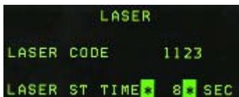
El scratchpad está ahora en Laser Time. Cualquier pulsación de las teclas del ICP cambiará el valor numérico. Por ejemplo, pulsamos 1 y después 2 y Laser Time cambiará a 12 segundos cuando se pulse la tecla ENTR.
