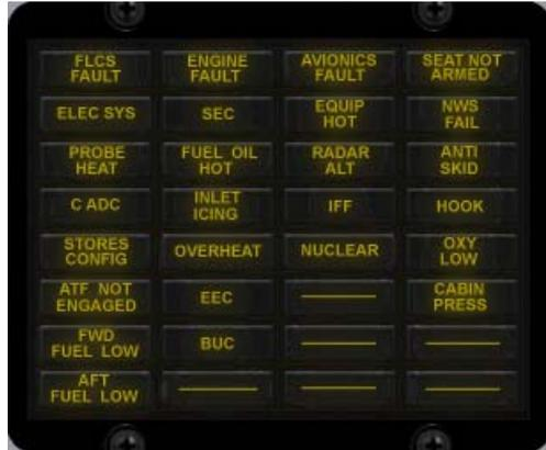
El panel de luces de precaución cuenta con 26 lámparas de color ámbar. Cada una se iluminará cuando se detecte un fallo en algún sistema relevante. Para una descripción completa de cada luz, consulte las checklists de emergencia. Checklists\_EP\_0612.pdf
