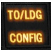
Esta luz de alarma se refiere a una configuración incorrecta para el aterrizaje o despegue.
