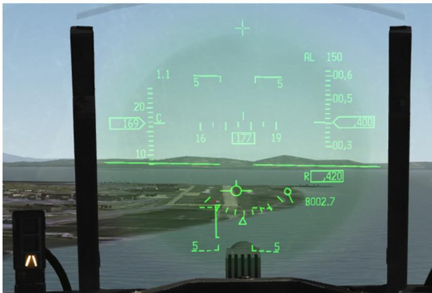
FPM debe estar justo en el umbral de la pista y el PAPI debe indicar dos luces rojas y dos blancas. La imagen de la izquierda representa la situación a pesar de que el AOA es demasiado bajo y rápido. El throttle se redujo pues para aumentar el AOA y llevar el FPM a la parte superior del corchete.
