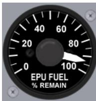
El medidor EPU indica la cantidad de combustible restante de la EPU (hidracina).
