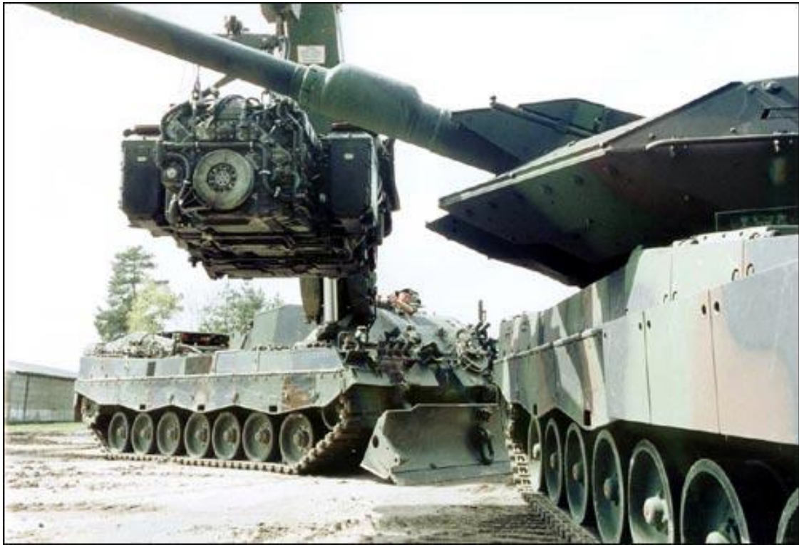
El Bueffel és capaç d'aixecar 30.000 kg. i canviar el Leopard 2A5 powerpack dins 35 minuts. (Foto: Krauss-Maffei Wegmann GmbH Co KG).
