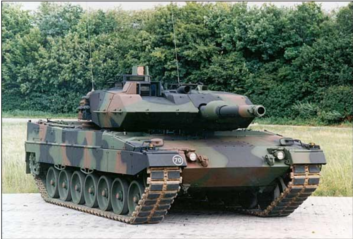
Leopard 2A5 KWS II: nova torreta i blindatge compost de tercera generació. (Foto: Krauss-Maffei Wegmann GmbH Co KG.)
