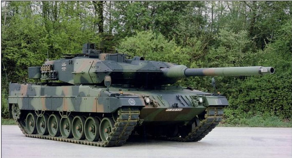
Leopard 2A6,, amb el nou canó de 120 mm en 2A6 de Rheinmetall. (Foto: Krauss-Maffei Wegmann GmbH & Co KG.)
