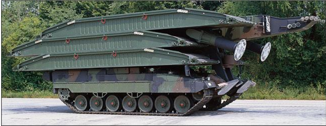
El Leguan Bridge sistema modular (Panzerschnellbrücke 2), amb la combinació de ponts de 3 x 9,7 metres. (Foto: MAN Mobile Bridges GmbH).
