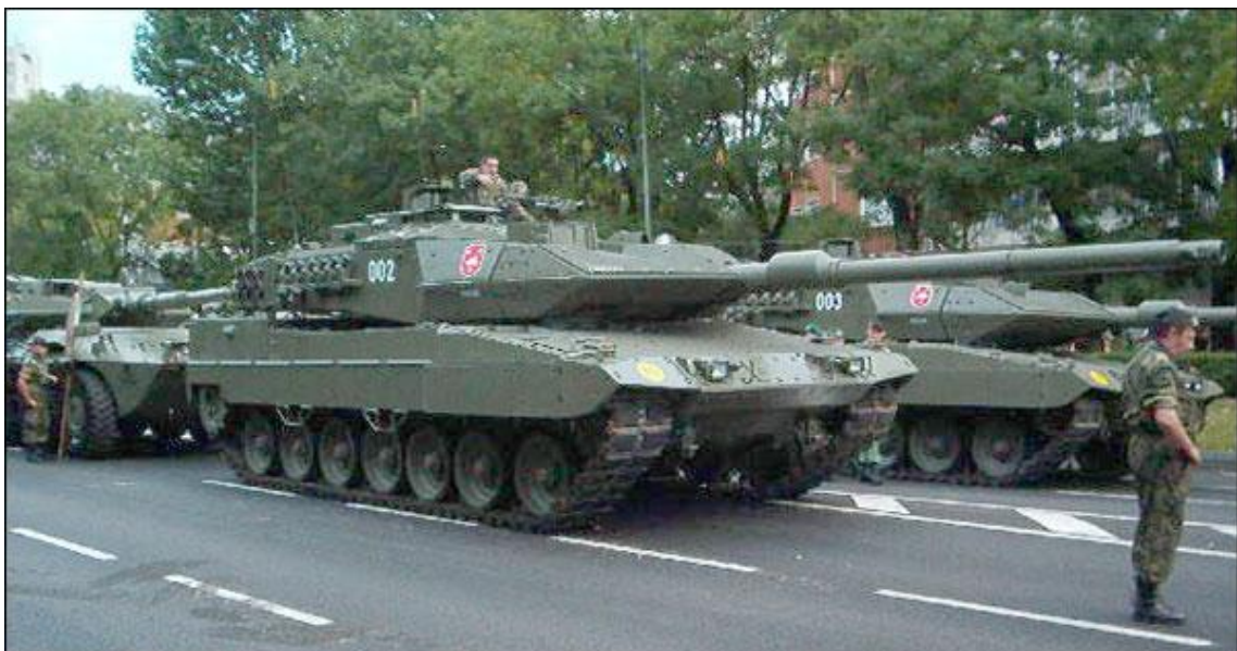
Lleopard 2E, mostrant l'augment total de 130 cm de longitud de barril del nou canó de 120 mm en 2A6. (Foto: cercle Trubia.)
