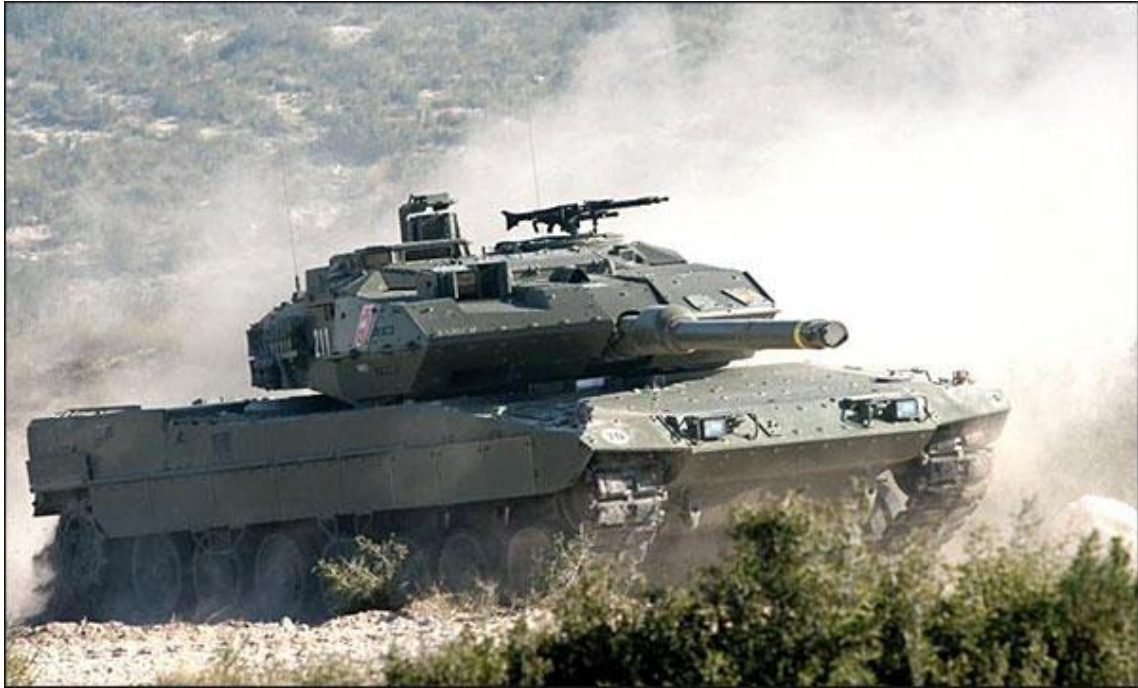
El Lleopard 2E, de l'exèrcit, mostrant el blindatge extra sobre el casc frontal i el nou canó de 120 mm de 2A6.
